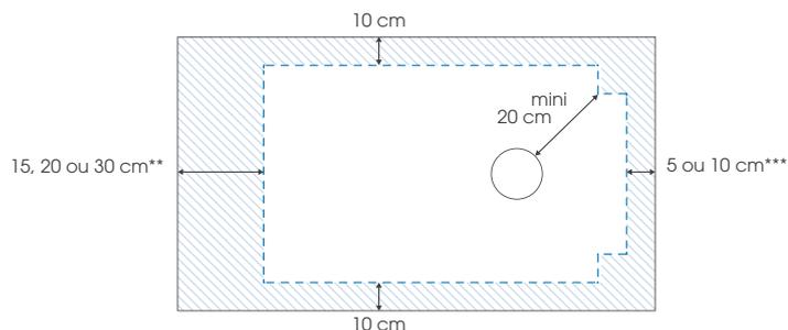
Zone maximale de découpe (si le receveur n'est pas totalement encastré, les côtés découpés doivent être positionnés contre les murs)
