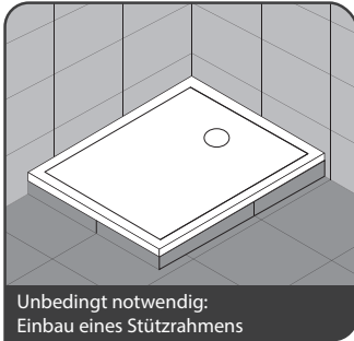
Montage auf Fertigfußboden mit Wannenfüßen und Fliesensockel
