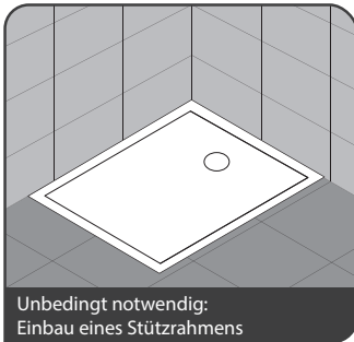
Bodengleiche Montage mit Wannenfüßen
